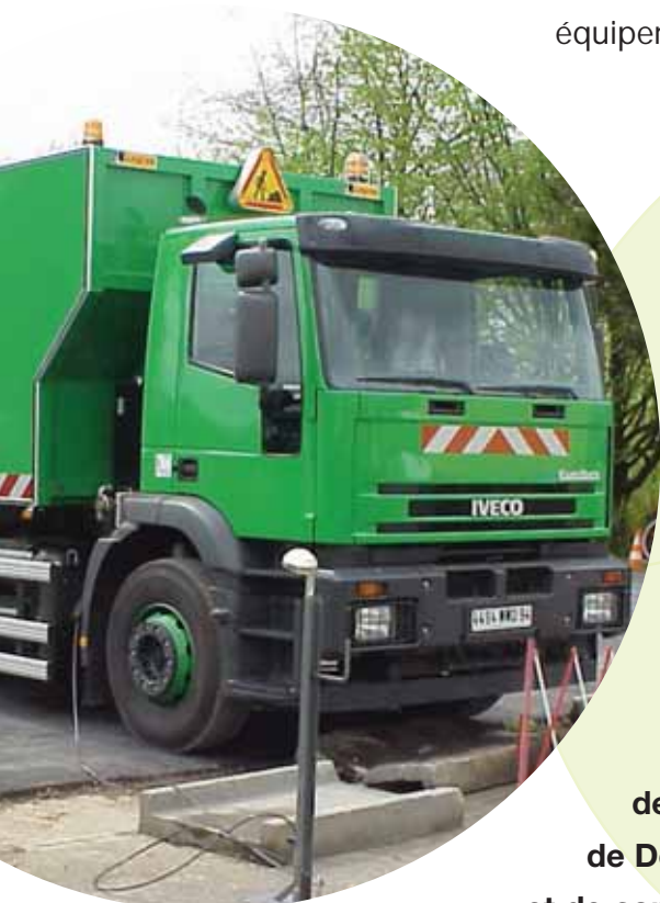
Benne à ordures ménagères fonctionnant au Gaz Naturel Véhicules (GNV)
